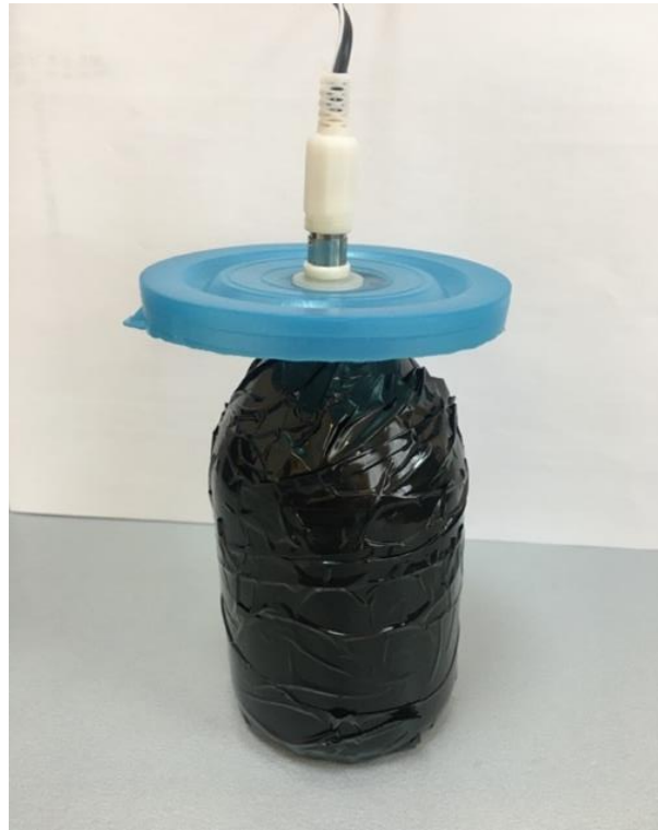
Рисунок 2.10 – Ионизация физиологического раствора ионами серебра аппаратом «Серебряный источник»
