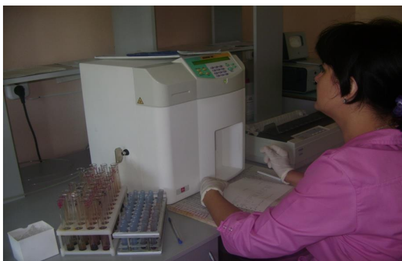
Рисунок 2.11 - Гематологический автоматизированный аппарат, который используется для проведения диагностики in-vitro на основании образцов цельной крови – анализатор ABX MICROS 60-OT.
