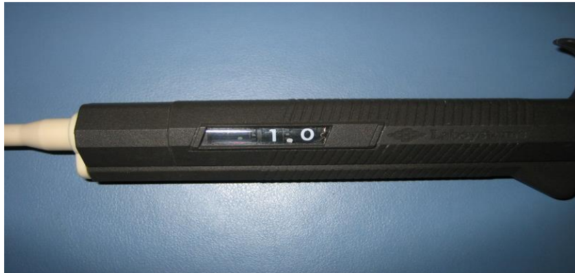
Рисунок 5 – Универсальная пипетка с автоматическим дозатором для нанесения на эмаль деминерализующего раствора
