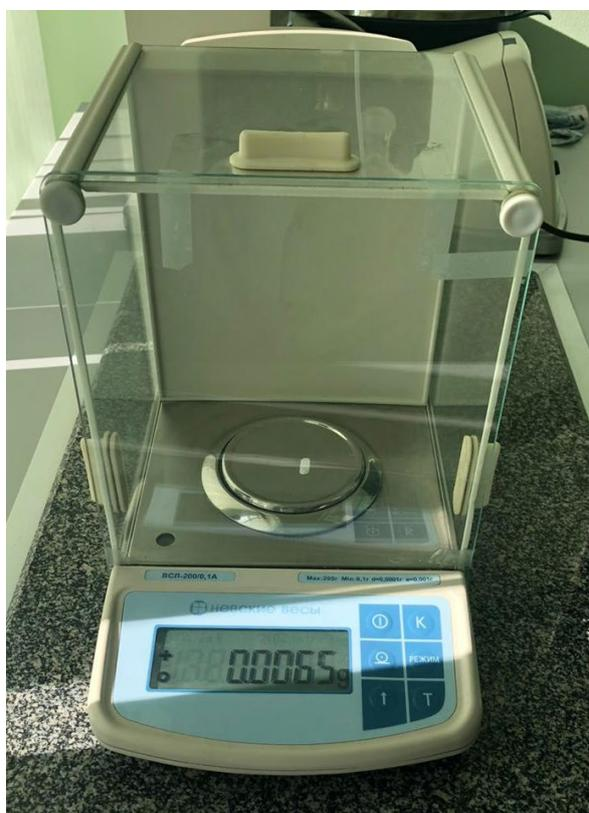
Рисунок 1 – Аналитические весы, использованные в исследовании (разрешение – 0, 00001 грамм)
