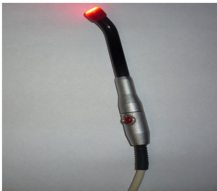
Рисунок 5. Наконечник активатора светодиодного «LED актив 05»
