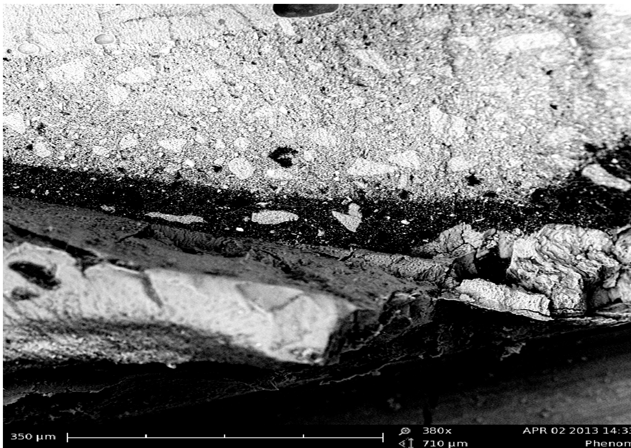
Рис. 29. Электронная микроскопия области уступа опорного зуба на границе ТТЗ-композит (группа №1, PHENOM; X 400).
