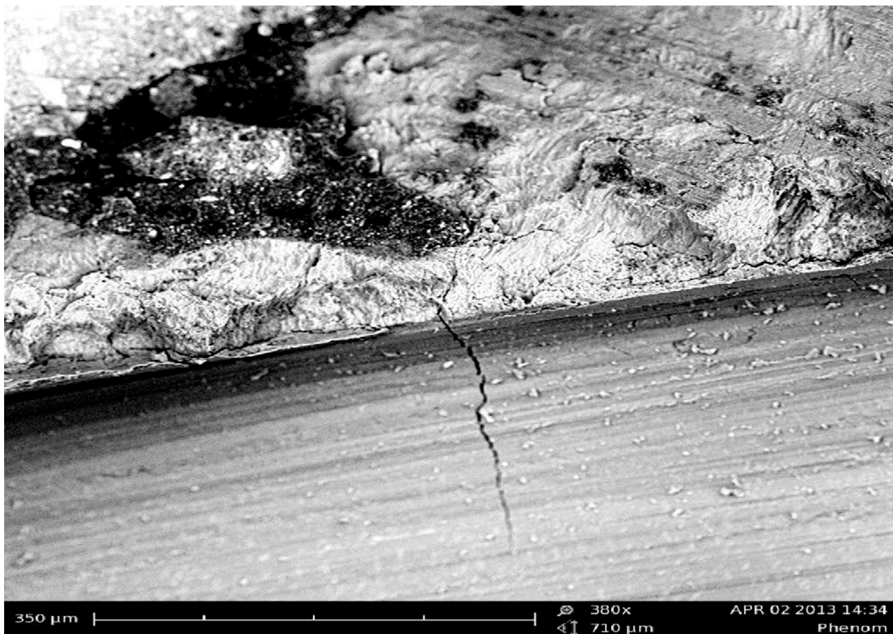
Рис. 36. Электронная микроскопия области уступа опорного зуба на границе ТТЗ-композит (группа №2, PHENOM; X 400).
