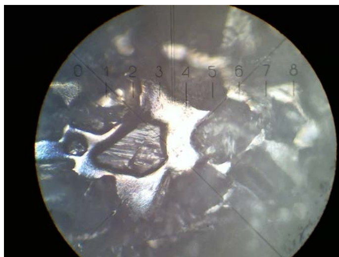
Рис. 15. Напыление алмазного абразива на вершине торцевой части боров типа CA(RA) STANDART RA 879/014.
