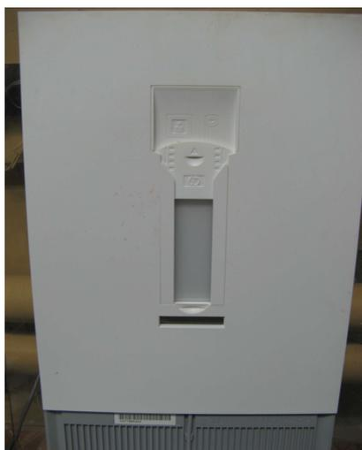
Рисунок 2.7 – Устройство в крышке сканера, необходимое для сканирования восковых пластинок на просвет
