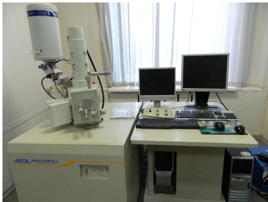
Рисунок 2.18 - Используемый растровый электронный микроскоп JSM 6380 LV (JEOL, Япония)
