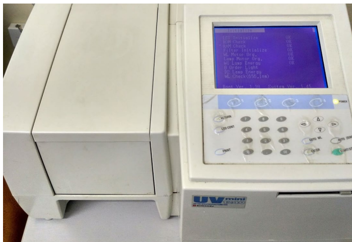
Рисунок 2.4 - Спектрофотометр SHIMADZU UV-1280, позволяет проводить измерения в УФ и видимом диапазоне спектра от 190 до 1100 нм с шагом 2 нм.
