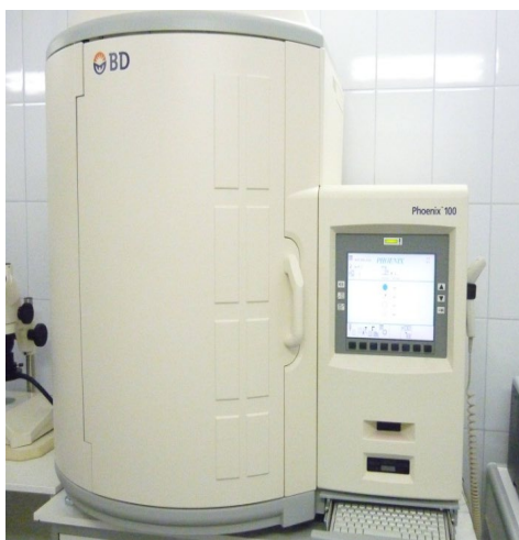
Рисунок 2.6 - а) автоматический анализатор для идентификации микроорганизмов Phoenix TM 100, Becton Dickinson; б) панель для идентификации микроорганизмов (ID-панель, на G^+ , G^- микрофлору)
