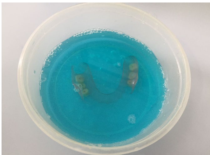
Рисунок 2.10 - Исследуемый съёмный протез, помещённый в раствор «Дентасептин \text{Ag}^+ »
