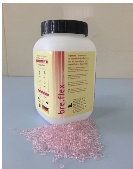
Рисунок 2.11 - Термопластического полимер на основе полиамида Bre.Flex (Германия)
